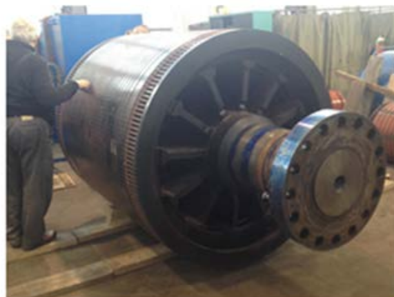
Rysunek 12. Zdemonтовany wirnik w zakładzie remontowym
