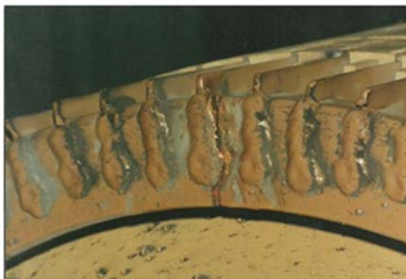
Rysunek 6. Pęknięty pierścień i uszkodzone spawy w klatce wykryte w silniku wentylatora poddmuchu w jednej z elektrociepłowni, w oparciu o wynik pomiaru pokazany na rysunku 5
