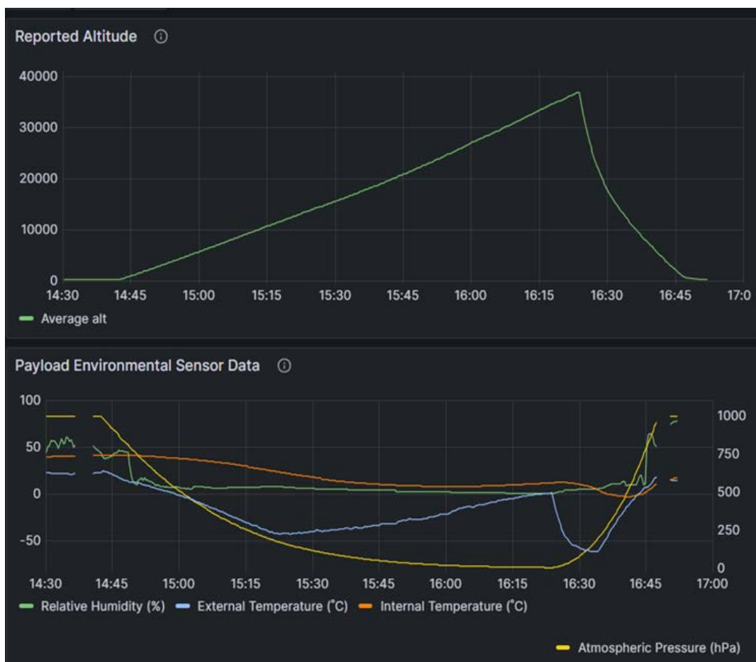
Rysunek 7. Przebieg czasowy wysokości [m n.p.m.] (górny wykres) oraz wielkości fizycznych atmosfery (dolny wykres): wilgotności względnej [%] (zielona linia), temperatury na zewnątrz kapsuły [°C] (niebieska linia), temperatury wewnątrz kapsuły [°C] (pomarańczowa linia) i ciśnienia atmosferycznego [hPa] (żółta linia) zmierzonych podczas III misji stratosferycznej – Szczepanik 3 [24]
